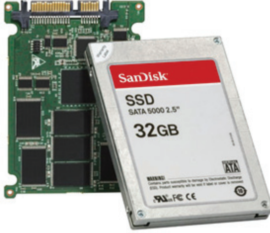
Şekil 44. Solid State Driver kalıcı hafıza birimi. Dış ve iç yapısı
