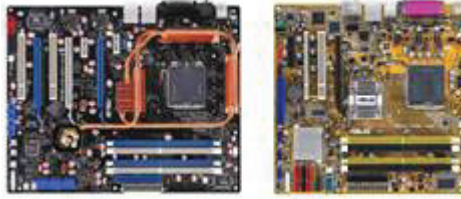
Şekil 7. ATX ve mATX anakart yapıları
