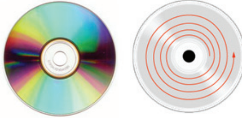
Şekil 58. Optik disk ve veri kayıt biçimi
