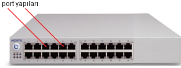
Şekil 76. 24 portlu bir switch
