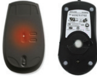
Şekil 85. Optik ve mekanik farenin alttan görünüşü
