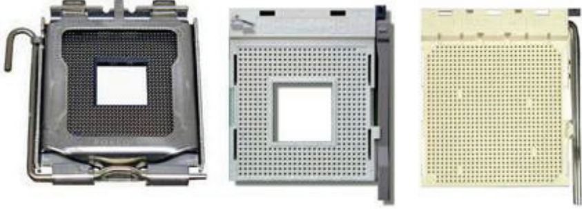
Şekil 23. Sırayla sağdan sola Intel LGA775, Intel 478 ve AMD AM2 940 pin soket yapıları
