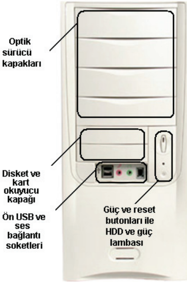
Şekil 113. I. kasanın içyapısı, II. kasanın ön yüzü, III. kasanın arka yüzü
